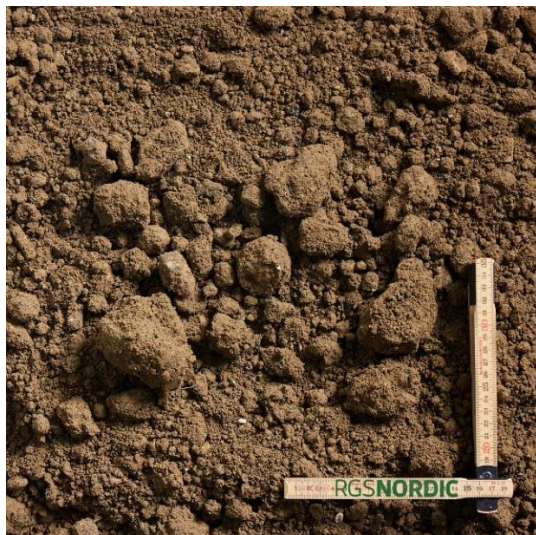
Kalkstabiliseret jord (KSJ)
